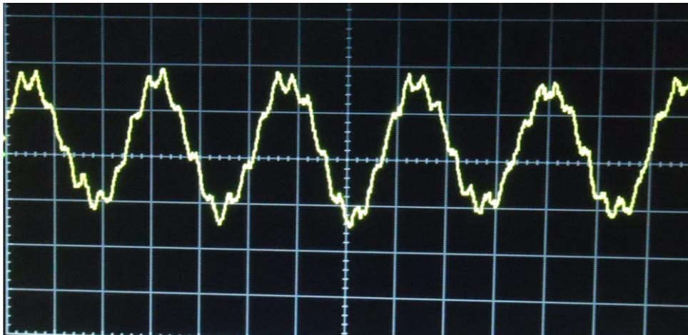
Рис. 3. Осциллограмма разрядного тока ЕВЧР в неоне при  $p = 0,1 \text{ Тор}$ ,  $V_{\sim} = 1500B$ ,  $f = 7 \text{ МГц}$ .
