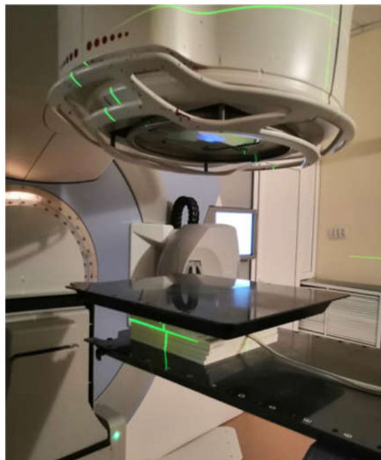
Рис. 2. Измерение заряда M_{raw} в фантоме при наличии деки стола.
