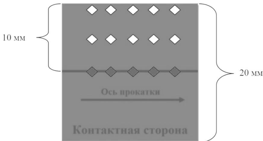
**Рис. 1.** Принципиальная схема измерения микротвёрдости, где цветом выделены различные серии испытаний
